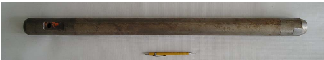
Foto 1 – Amostrador-padrão “Raymond” (NBR 6.484 / 2001) – Fechado.
