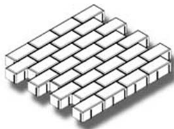
Figura 17 – Bloco intertravado a ser utilizado (Retangular 10x20x6cm)
