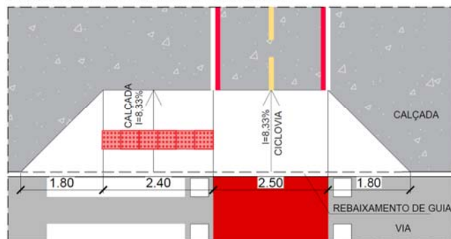
Figura 25 – Rampa pedestres e ciclista - padrão
