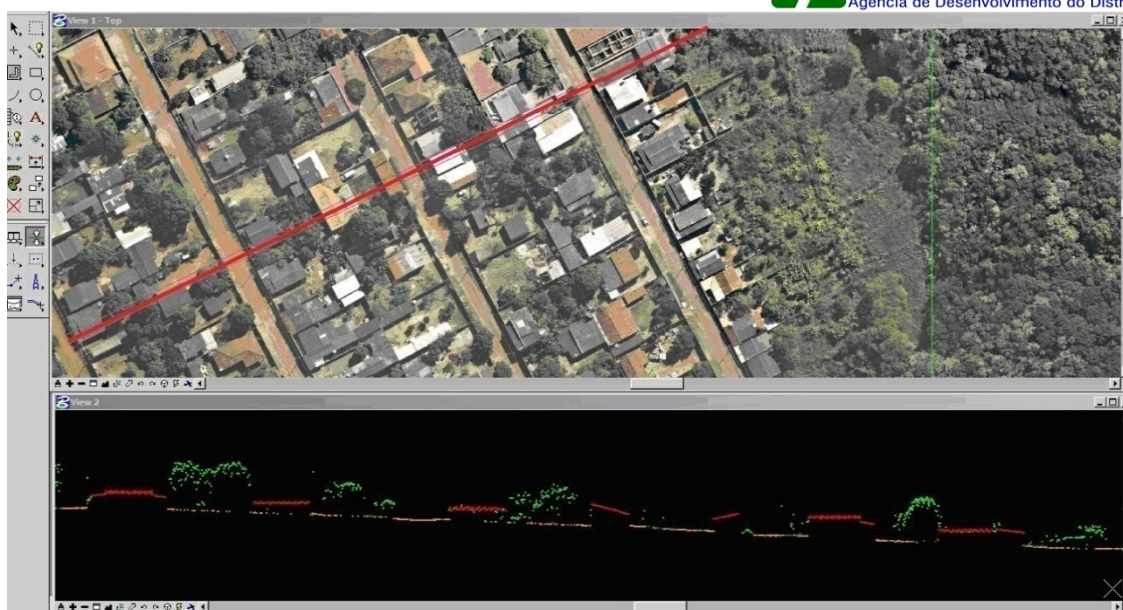
Figura 4: Exemplo de dados obtidos com a execução do perfilamento Laser.
